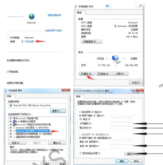
B: 编辑本机信息。进入系统后, 出现测试介面, 先关闭测试介面, 选择“本机信息”, 输入数据库IP(接收数据电脑IP), 其它不变, 点“保存设置”, 关闭该窗口后会自动启动。
